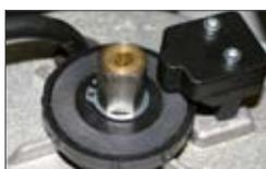
Frizione meccanica bidisco per regolazione della forza (solo per SATURN OIL)
